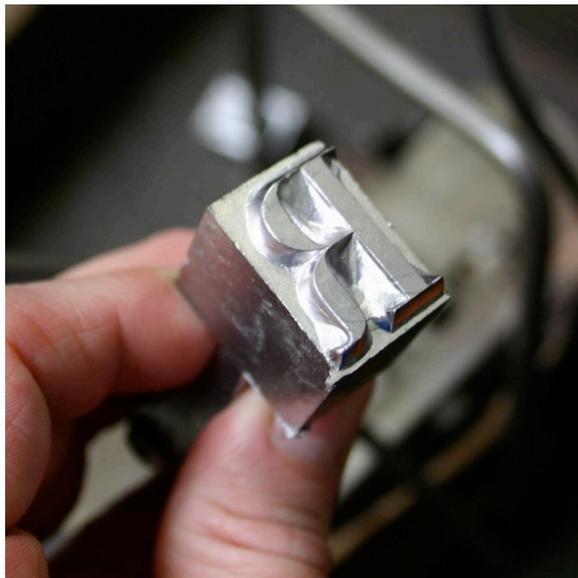
Mit dem Handgießinstrument gegossene Bleiletter
